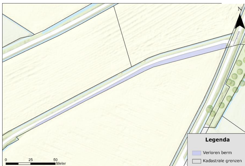
Figuur 3. Zandweg B33, waarvan een deel van de berm verloren is gegaan door onrechtmatig grondgebruik.
